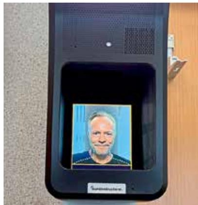
Das PointID-Gerät kann zur Aufnahme von digitalen Passfotos direkt im Rathaus verwendet werden. Es ist höhenverstellbar, einfach in der Bedienung und zeichnet sich durch modernste Sicherheitsstandards aus. Die Nutzung kostet 6 Euro.
